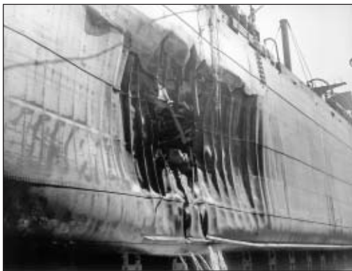
DOMMAGES CAUSÉS À LA COQUE DU FORT CAMOSUN PAR L'EXPLOSION D'UNE TORPILLE. (ANC PA190186)
